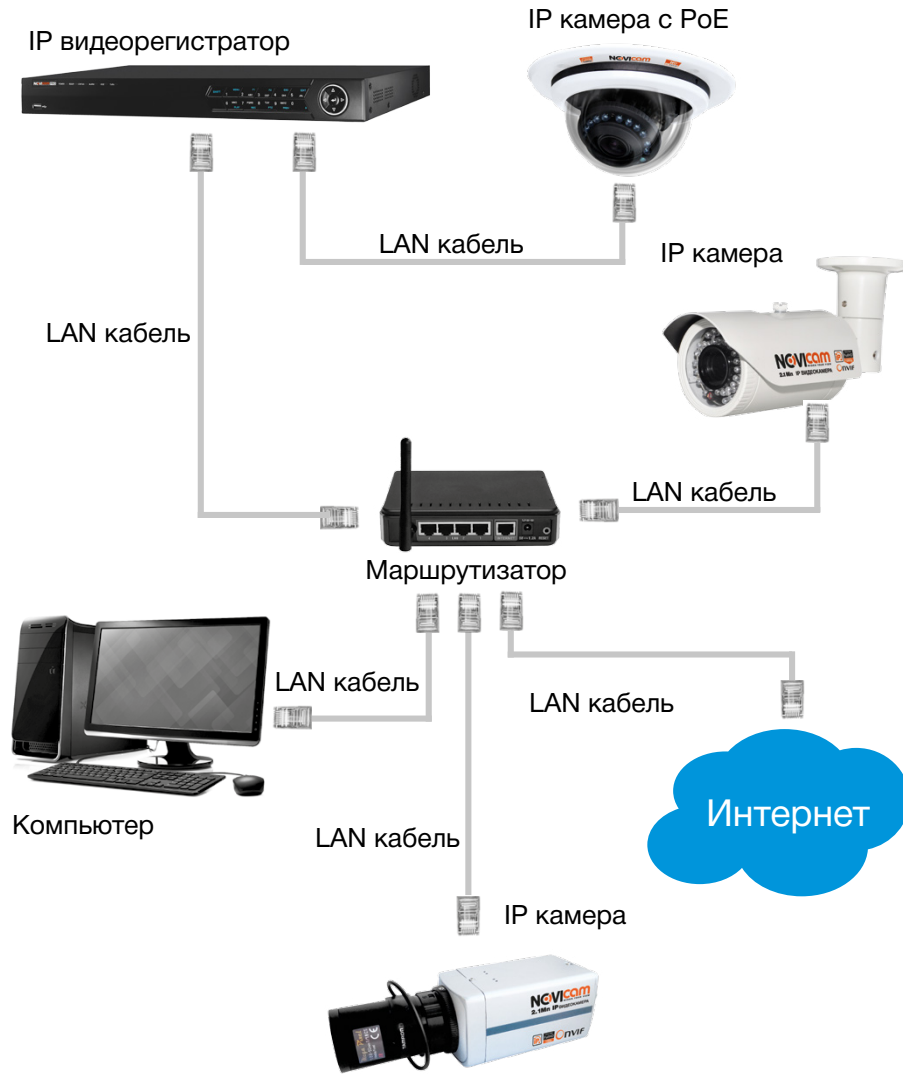
Рисунок 3.19 Подключение IP видеорегистратора с PoE.
