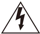
Пиктографический знак сверкания молнии со стрелкой в равностороннем треугольнике предупреждает пользователя о наличии в кожухе прибора неизолированного высокого «опасного напряжения», могущего создать опасность поражения электрическим током.
